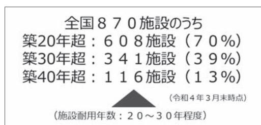
図3 し尿処理施設・老朽化の現状
